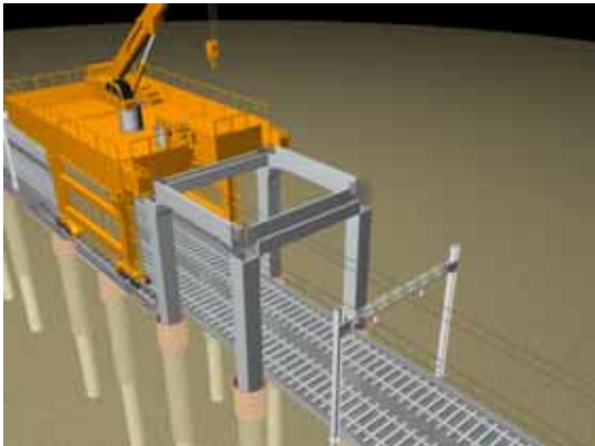
ハーフプレキャスト梁の架設
